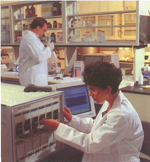
Alfa Spektrometresi (Uranium seri analizlerinde kullanılır).
